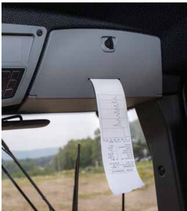
Встроенный принтер: для документирования значений уплотнения
