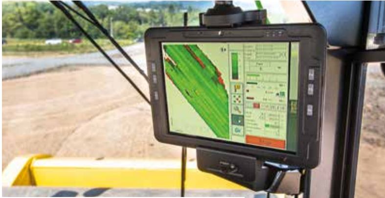
Цветом показаны наглядные карты объекта с указанием степени уплотнения
