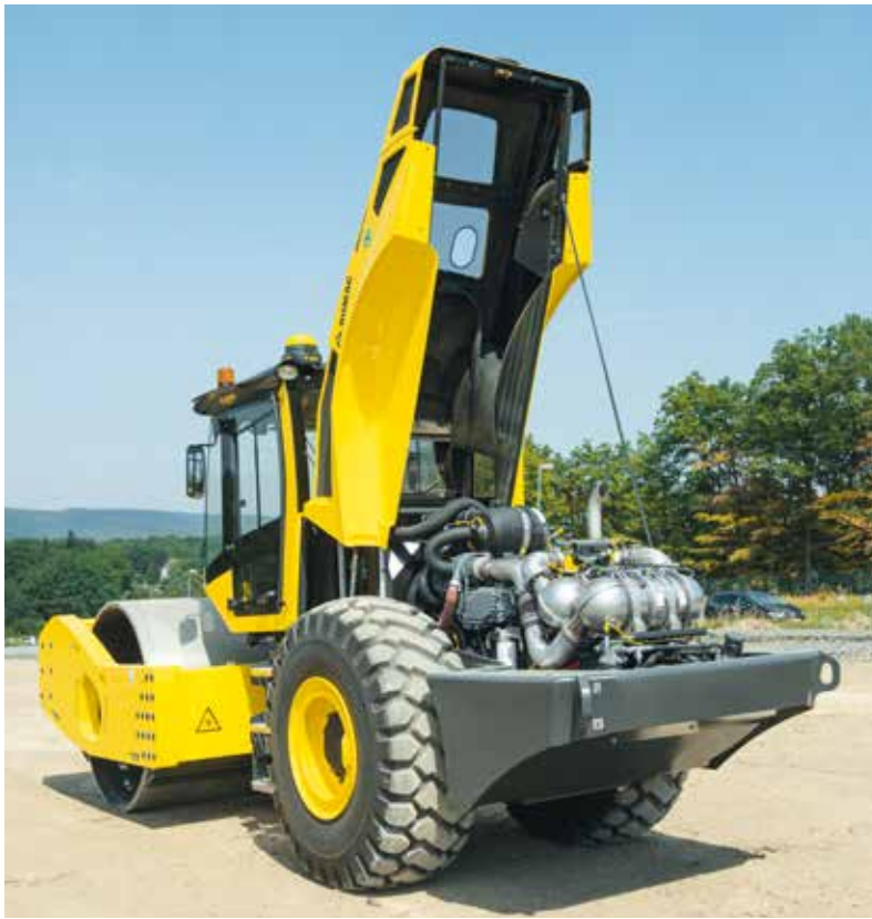
Простота доступа ко всем узлам для проведения технического обслуживания благодаря большому капоту
