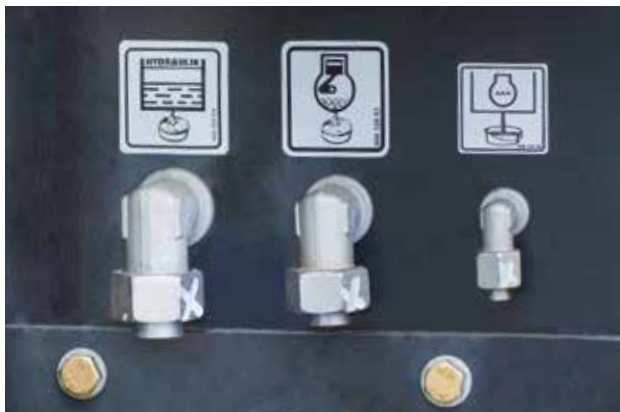
все сливные патрубки сосредоточены в одном месте и доступны с земли
